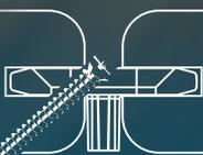
No Modelo BR, os parafusos devem ser aplicados em um ângulo de 45°, ingressando através da régua de madeira pela parte inferior da fêmea e entrando na sequência no barrote ou viga. NUNCA aplicar em 90°.
