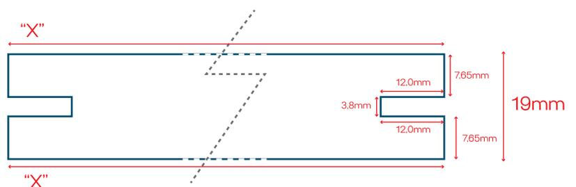
O valor de "X" corresponde à largura da superfície aparente do deck, no modelo BR, o cliente pode ainda recuar em 2mm a base inferior (sendo 1mm para cada lado), diminuindo o espaçamento entre reguas de 4mm para 2mm.
