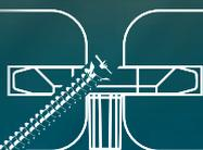
No Modelo BR, os parafusos devem ser aplicados em um ângulo de 45°, ingressando através da régua de madeira pela parte inferior da fêmea e entrando na sequência no barrote ou viga. NUNCA aplicar em 90°.
