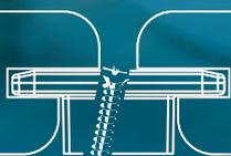
No Modelo CE, os parafusos serão aplicados conforme direcionamento automático do canal maciço da peça, não devem ser feitos furos ou adaptações pois poderiam comprometer a estrutura e fixação.
